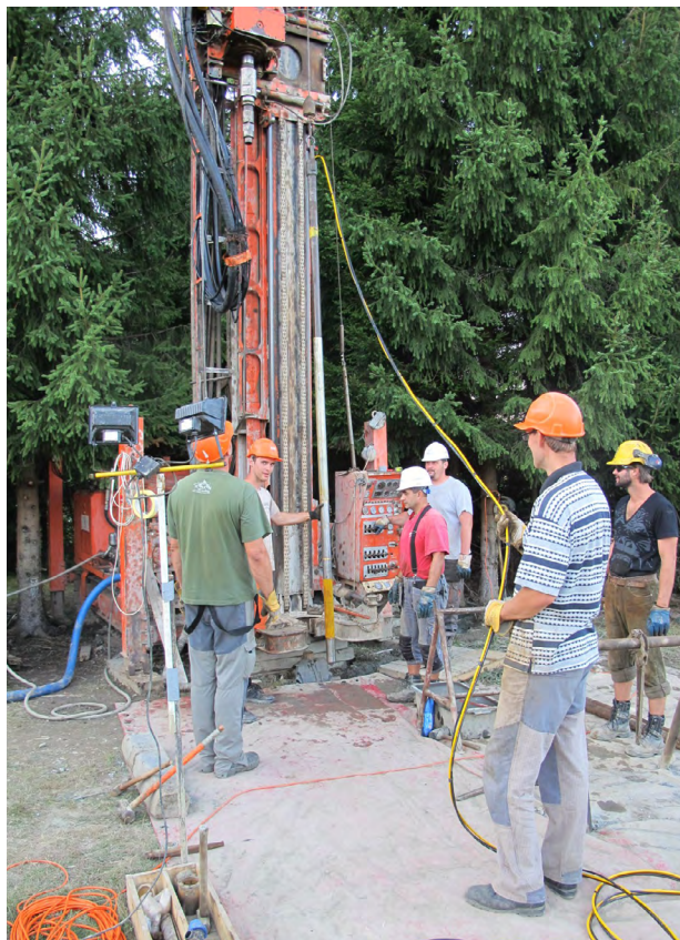
Obr. 2. Sonda dilatometra pripravená na spúšťanie do prieskumného vrtu CZ-08.
