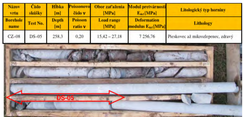
Obr. 10. Vrtné jadro z vrtu CZ-08 z hĺbky 256,0–260,5 m. Kompaktné masívne pieskovce až mikrozelepence s preplástkami tektonicky porušených pestrých ílovcov. Fig. 10. Core recovery of borehole CZ-08 from depth 256,0–260,5 m. Compact massive sandstones or fine-grained agglomerates with intercalations of tectonically disrupted versicolour claystones.
