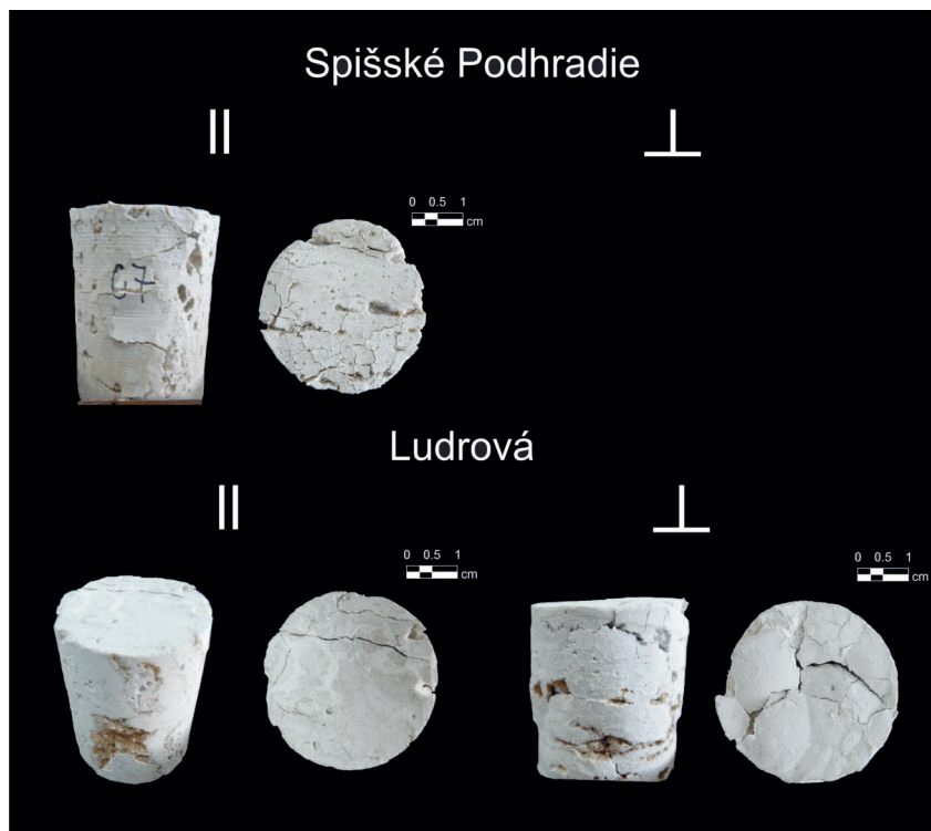
Obr. 4. Travertín zo Spišského Podhradia a Ludrovej po teplotnej záťaži 800°C.
