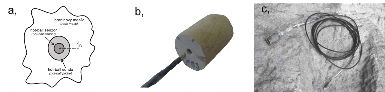
Obr. 5. „Hot-ball“ sonda zostrojená na základe „hot-ball“ metódy. a) princíp „hot-ball“ metódy (upravené podľa Kubičár et al., 2006); b) „hot-ball“ senzor a teliesko horniny; c) „hot-ball“ sonda pripravená na osadenie do skalného masívu.
