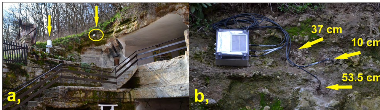
Obr. 4. Lokalita Brhlovce skalné obydlie: a) lokalizácia osadenia „hot ball sond“ a zrážkomernej stanice (vľavo); b) detail priestorového rozmiestnenia „hot-ball“ sond spolu so solárne napájanou záznamovou jednotkou.
