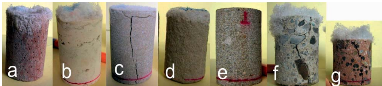
Obr. 8. Prejav kryštalizácie síranu sodného ( \text{Na}_2\text{SO}_4 ) na skúšobných vzorkách kameňov (a – rhyolit/ Hliník nad Hronom; b – travertín/Spišské Podhradie; c – pieskovec/Hertník; d – pieskovec/Králiky; e – pieskovec/Livovská Huta; f – umelý kameň /Danavorava; g – umelý kameň/Vaspo). Fig. 8. Impact of the sodium sulphate crystallisation on stone samples (a – rhyolite/ Hliník nad Hronom; b – travertine/Spišské Podhradie; c – sandstone/ Hertník; d – sandstone/Králiky; e – sandstone/Livovská Huta; f – agglomerated stone /Danavorava; g – agglomerated stone/Vaspo).
