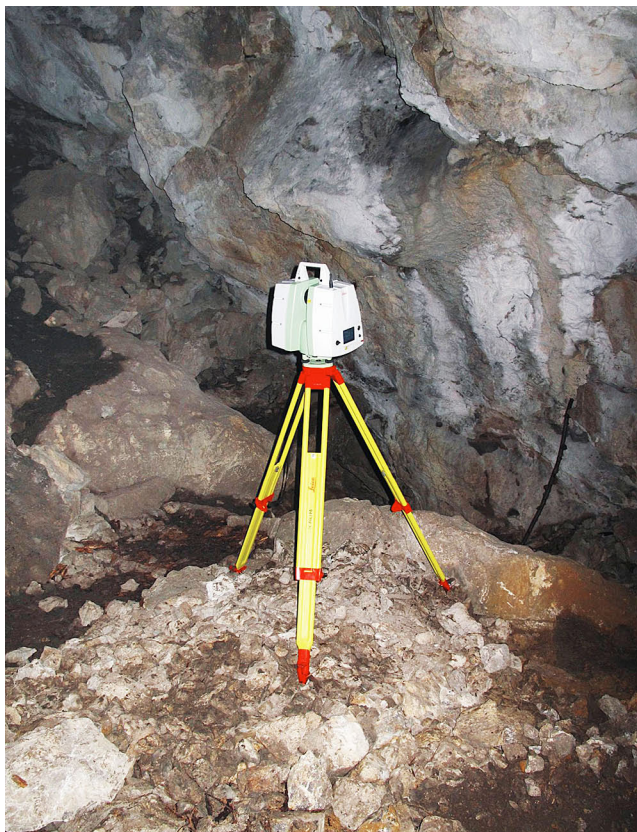
Obr. 4. Laserové skenovanie jaskyne Dúpnica. Foto: P. Bella.
