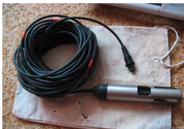
Obr. 1. Konduktometer typu Cond 330i/SET a 20 m dlhý kábel ukončený sondou (foto Petrydesová, 2008).
