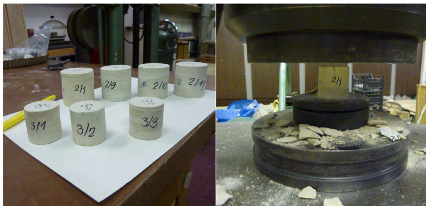
Obr. 5. Skúšobné telieska (vzorky pieskovca z lokality Chtelnica-Malé Skalky) vľavo, vpravo – vzorka po skúške v prostom tlaku (foto Holzer, 2013).
