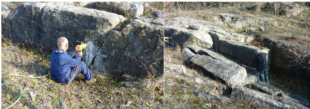
Obr. 4. Kameňolom Chtelnica-Malé Skalky: odber vzoriek pomocou prenosnej jadrovej vŕtačky a pohľad na ťažobné ryhy (foto Holzer, 2013).
