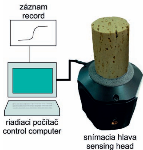
Obr. 3. Schéma povrchového profilometra Traceit® (vľavo) s fotografiou snímačnej hlavy a vzorkou travertínu zo Spišského Podhradia (vpravo).
