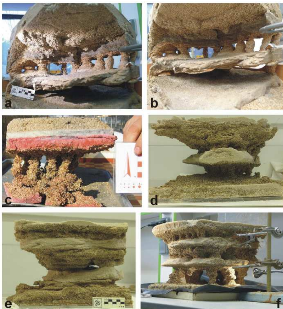
Obr. 2 Výsledky experimentov s kontrastným zvrstvením. (a-b) Väčšina stĺpov je vyvinutých vo vrstve uprostred, menej v spodnej vrstve. Horná vrstva hrubozrnného piesku je takmer celá litifikovaná. Viacero stĺpov je buľovito zhrubnutých. (c) Raný experiment s pevnou plastovou nádobou. Stĺpy sú vyvinuté iba v strednej vrstve, viacero z nich bolo deštruovaných pri vpremiestňovaní modelu z nádoby. (d) V dôsledku rýchleho prúdenia sa väčšina stĺpov spojila v jeden centrálny, na jeho okrajoch je však stále vidieť reliktu pôvodných stĺpov. (e) V dôsledku použitia nadmerného množstva roztoku došlo k takmer úplnej litifikácii, s jednou zachovanou kavernou. (f) Najhrubšie a najväčšie stĺpy sa vyvinuli v spodnej vrstve, kde sa nachádza aj nedokončený stĺp.
